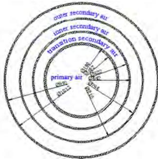
Fig. 1 DRB-4Z burner air duct structure
